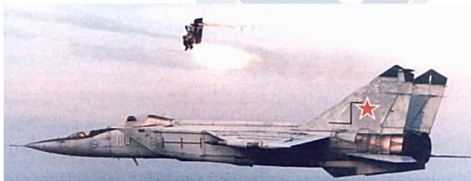
Les avions de chasse actuels, trop rapides, ne permettent plus de sauter en parachute. Le pilote est assis sur un siège éjectable.
