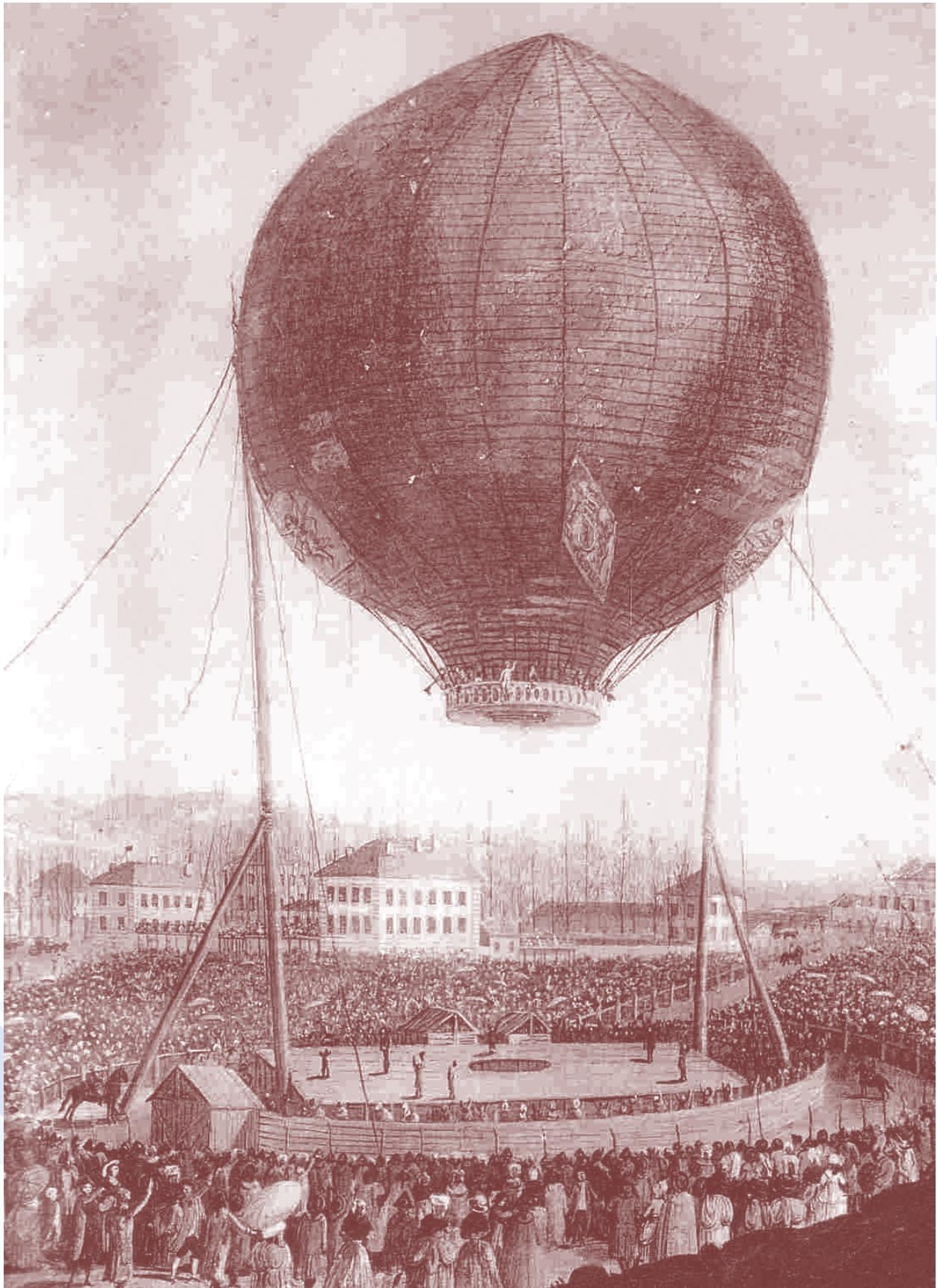
Joseph de Montgolfier fabrique le Flesselles, un ballon géant de quarante-deux mètres de hauteur et trente-quatre mètres de diamètre, équipé d'une galerie pour accueillir des passagers. C'est à bord de cet engin, piloté par Pilâtre de Rozier, qu'il embarque avec cinq autres personnes le 19 janvier 1784 à Lyon, et expérimente lui-même son invention au cours de ce qui restera son seul vol.
