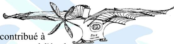
Une chauve-souris, la roussette, a inspiré à Clément Ader la forme caractéristique des ailes de son avion. Elles étaient constituées d'une armature en bois recouverte d'une membrane de soie fixée par 6500 boutons ! L'envergure totale atteignait 13,70 mètres.
