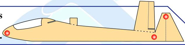
Glissez les deux flèches de l'aile dans les fentes du fuselage.
