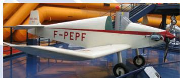
La robustesse de l'avion, sa simplicité de construction, facile à réaliser sans outillage spécial, intéressèrent rapidement les constructeurs amateurs. Plus de 900 exemplaires seront construits dans le monde entier, avec divers moteurs (Volkswagen, Panhard,...). Inchangés depuis 1947, les plans sont toujours vendus par la société des Avions JODEL pour 150 €.
