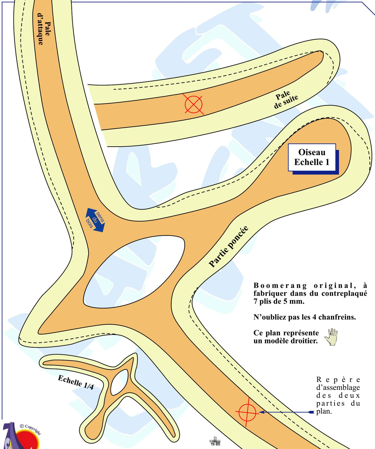
**Boomerang original, à fabriquer dans du contreplaqué 7 plis de 5 mm.**
