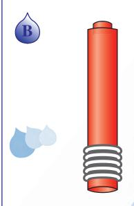
Equilibrez le ludion en enroulant plus ou moins de soudure (ou de la pâte à modeler résistant à l'eau, comme les pâtes adhésives) autour de la partie ouverte : dans un verre d'eau, il doit flotter en affleurant la surface.
