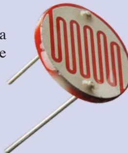
La principale utilisation de la photo-résistance est la mesure de l'intensité lumineuse (appareil photo, systèmes de détection, de comptage et d'alarme...).
