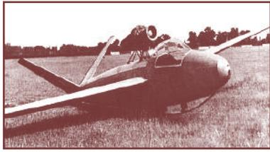
Le planeur **Fouga CM 813** (Castello-Mauboussin) servit de base au projet. L'empennage en **T** fut remplacé par un empennage en **V** pour
