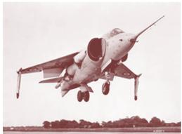
Le **P.1127**, construit à 6 exemplaires, teste dès 1960 le réacteur Bristol Pégasus à *poussée vectorielle*, qui a la possibilité d'orienter ses tuyères vers le bas ou l'arrière.
