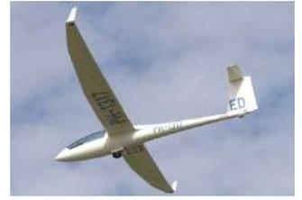
Le bord d'attaque de l'aile du Discus se rapproche de la forme d'un croissant, soit une forme quasiment idéale.
